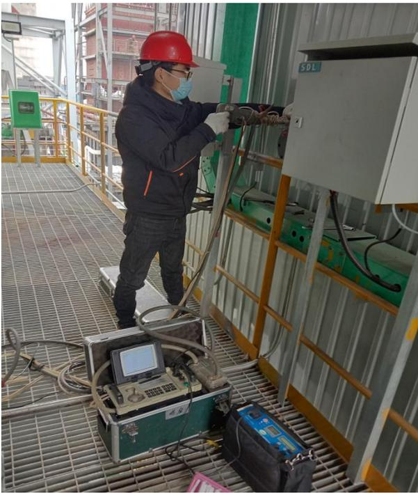
锅炉燃烧废气处理设施出口监测
