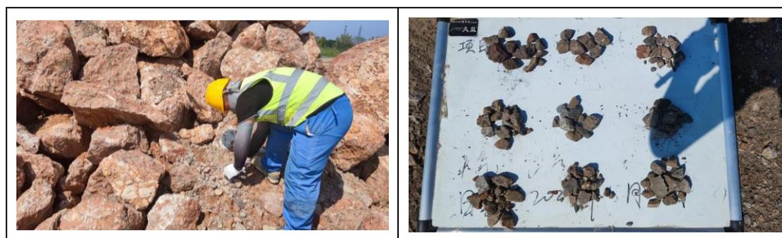
图7.1-3 建筑渣石堆体采样图
