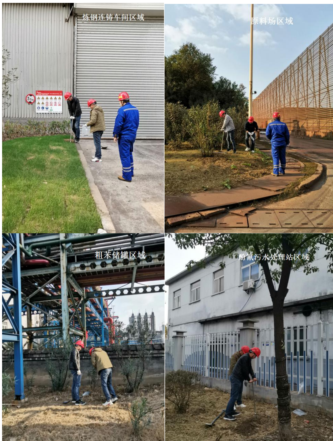
图6 现场土壤样品采集
