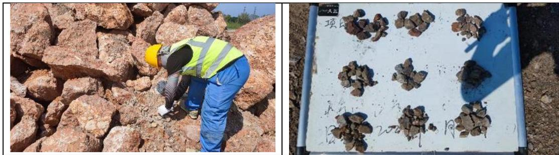
图7.1-4 建筑渣石堆体采样图
