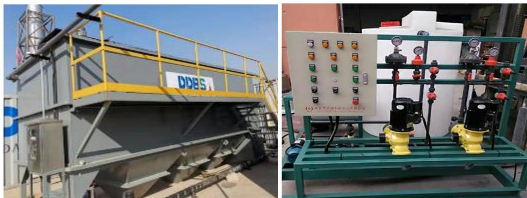
图 3.6-43 混凝沉淀池及配套设施
